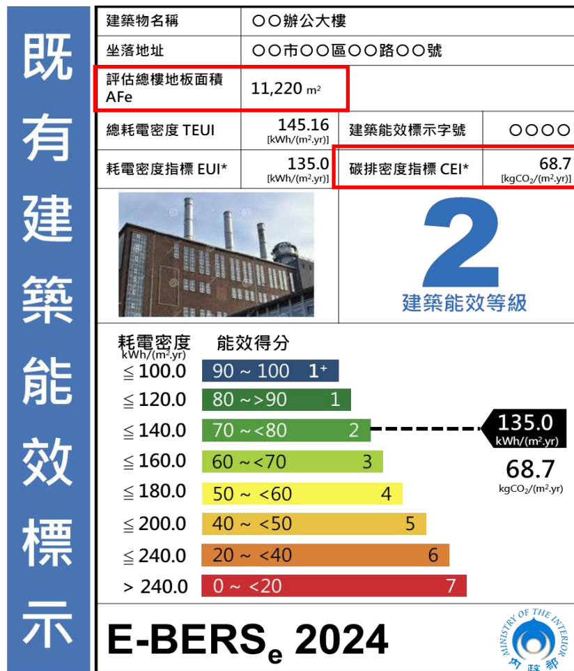
圖 7 既有建築類之建築能效標示圖例
